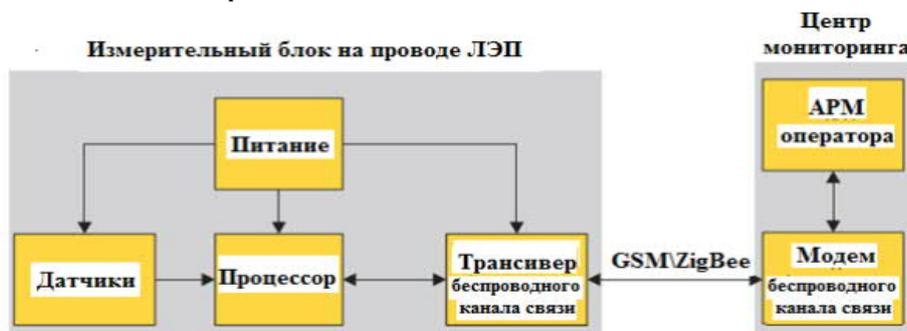
Рисунок 16 - Система мониторинга пропускной способности проводов ЛЭП
